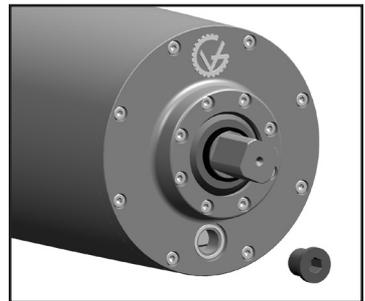
Pour vérifier le niveau d'huile, faites pivoter le tambour moteur jusqu'à ce que la flèche en relief de la flasque externe (modèle TM160-TM500), ou la plaque signalétique de la flasque externe (modèle TM127, acier doux uniquement) soit pointée sur 12 h 00. Le bouchon d'huile sera situé à environ 4 h 00. Le niveau d'huile doit effleurer le bouchon.\*
